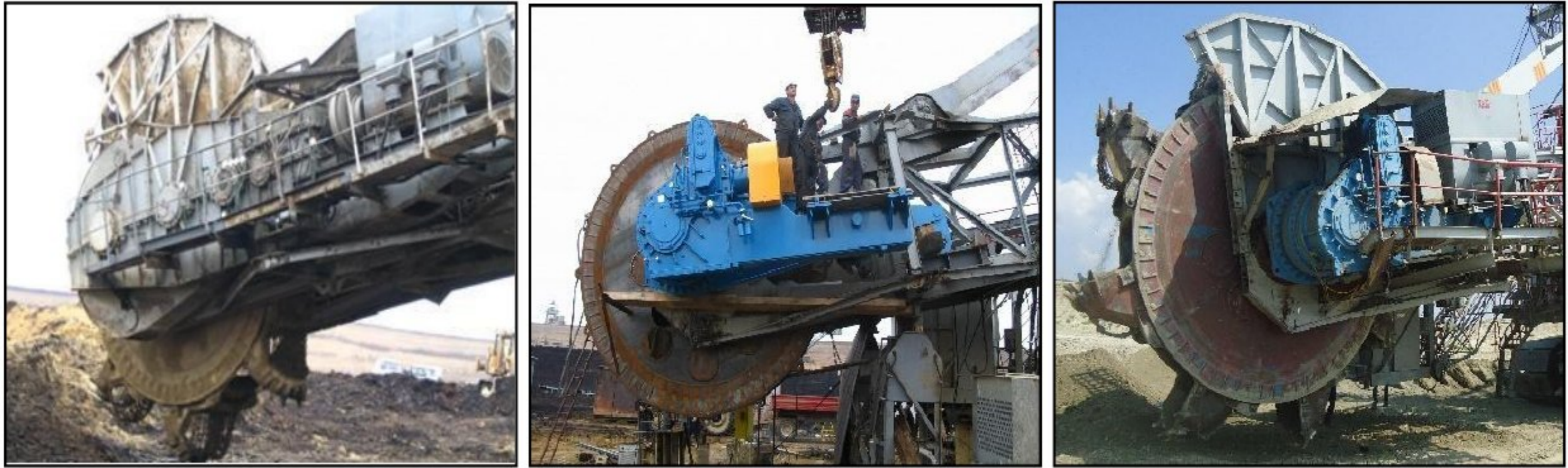
Слика 3.2. Глава радног точка багера SRs470.17/1.5 – пре и после ревитализације
