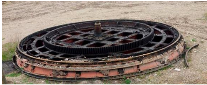
Слика 24. Доње постоље са зупчастим венцем багера дреглајна ЕШ10/70 [9]
