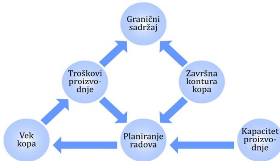
Slika 4.2. Kružni tok optimizacije proizvodnje na površinskom kopu (Sevim i Lei, 1998)
