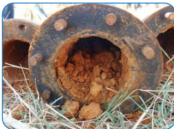
Slika 17.1. Talog \text{FeOOH} u potisnom cevovodu iz bunara na izvorištu Trnovče (Velika Plana) [49, 20]
