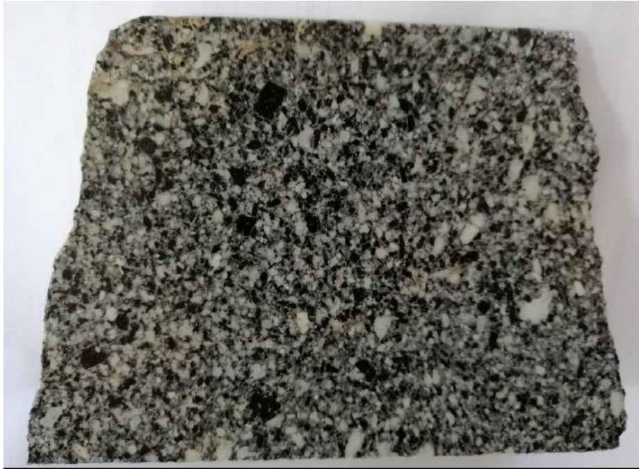
Slika 34. Sivi, sveži do slabo alterisani „FH“ andezit, TC170183, 561,5 m (Bosić, 2019).
