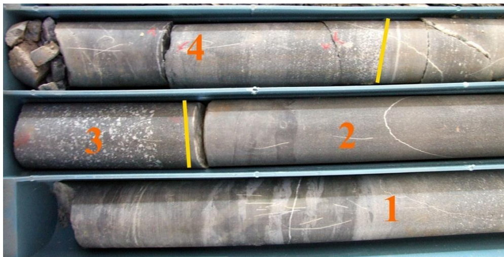
Slika 18. Izgled sekvenci (1, 2, 3 i 4) u razviću donjeg dela jedinice „Borski klastiti“ nabušenog sa FMTC 1339. Sekvenca 1 je peščar-finozrni klastiti, a sekvenca 2 peščar-peščar. Sekvence 3 i 4 u bazi imaju konglomeratične peščare.
