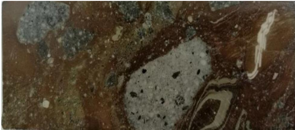
Slika 26. Tip 2 Andezitska breča sa laporovitim matriksom, FMTC1221, 510 m (Bosić, 2019).
