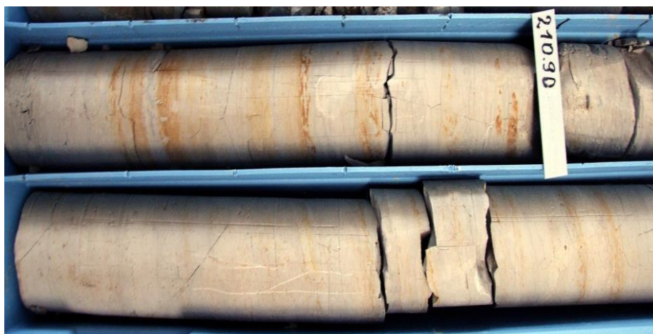
Slika 57. Sekundarna pigmentacija finozrnih klastita duž mehaničkih diskontinuiteta (laminacija i pukotine). Bušotina FMTC 1216 (Vasić, 2015).
