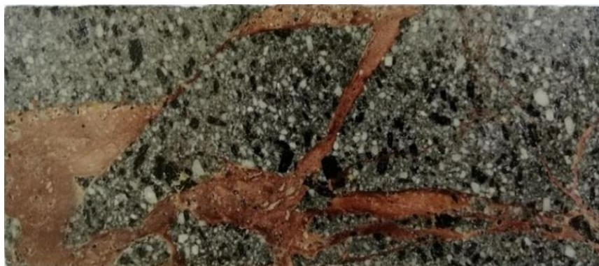
Slika 25. Tip 1 Andezitska breča sa laporovitim matriksom, FMTC1221, 520 m (Bosić, 2019).
