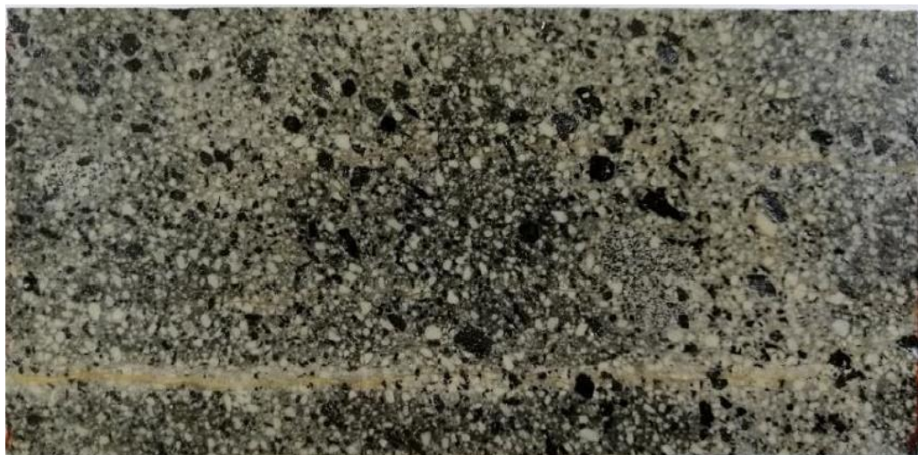
Slika 27.-Svež horblenda-feldspat-porfirski andezit, TC170197, 296.50 m (Bosić,2019).
