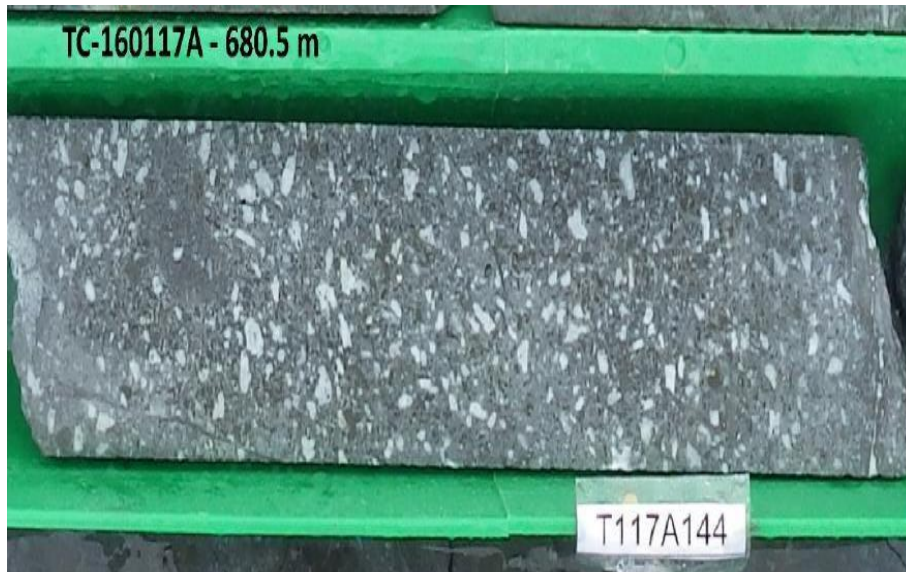
Slika 24. Slabo do srednje alterisan donji andezit (Tripp, 2017).
