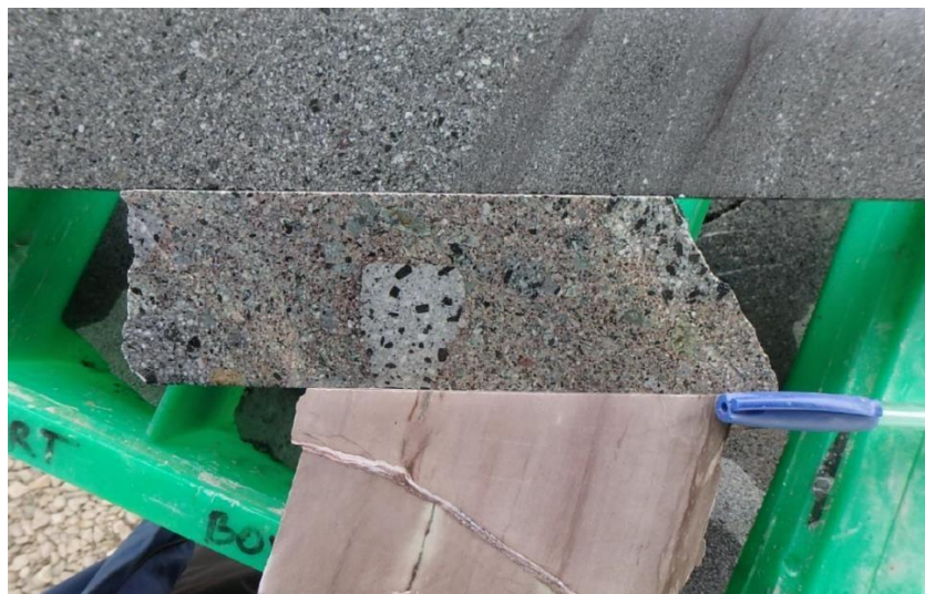
Slika 43. Uzorci koj predstavljaју laporovitu asocijaciju, TC17019R, gornja slika, peščar bogat kristalima, srednja slika, tip 2 andezitske breče sa laporovitim matriksom, donja slika, laminirani laporac (McPhie, 2018).
