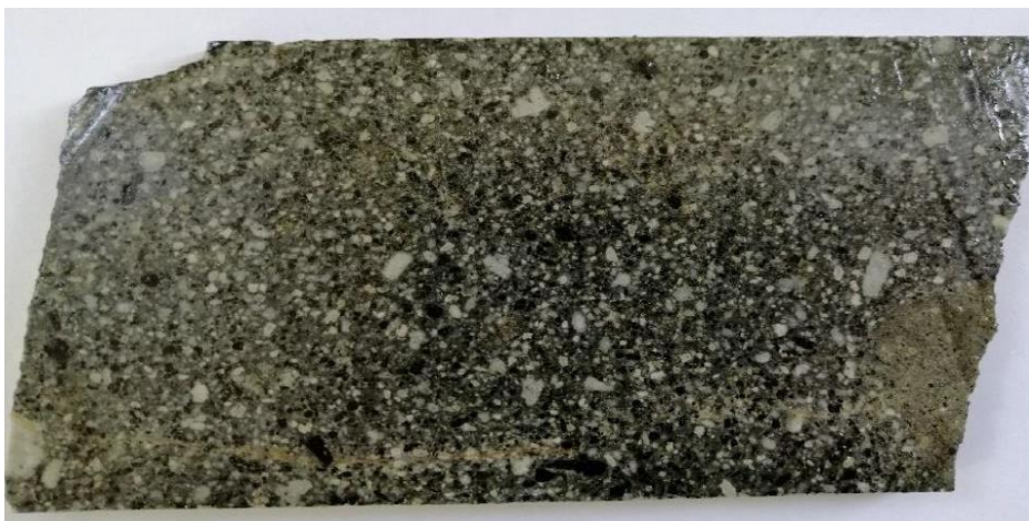
Slika 35. Sivi, sveži do slabo alterisani feldspat-horblenda phyric andezit, TC170177, 647,7 m (Bosić, 2019).
