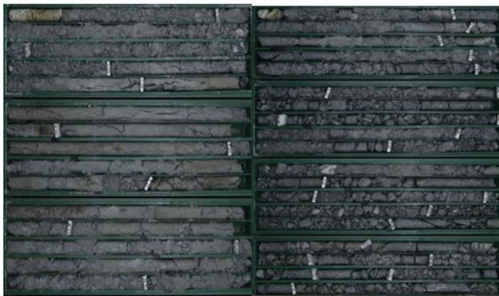
Slika 69. Primer rasednih struktura u jezgrima istražnih bušotina koje su izvedene iz jamskih prostorija.
