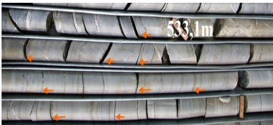
Slika 7. Tipski izgled sivih laporaca. Strelice pokazuju površi slojevitosti. Bušotina FMTC 1109 (Vasić, 2015).
