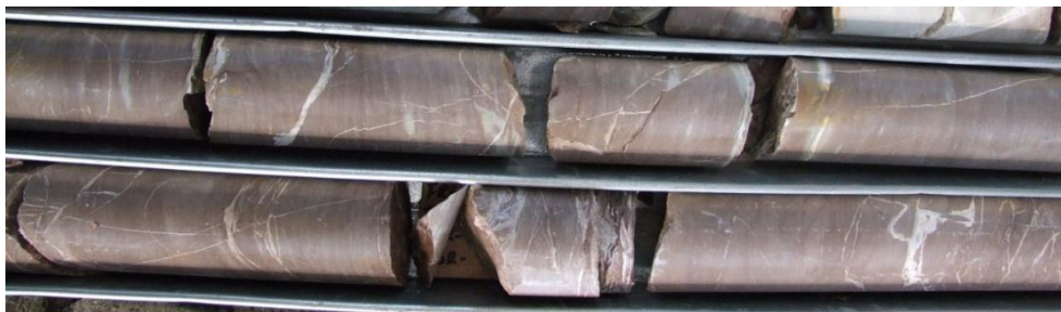
Slika 8. Crveni laporci na početku jedinice u bušotini FMTC 1109 (Vasić, 2015).
