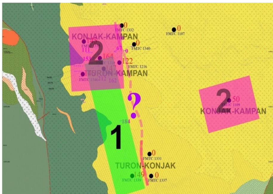
Slika 12. Stratigrafski opseg u jedinici „Laporci gornje krede“ na istraživanom prostoru i njeno vertikalno razviće. 1 – predpostavljeni prostor na kome je počela depozicija jedinice u vreme turona i 2 – predpostavljeni prostor na kome je depozicija jedinice završena u kampanu (Vasić, 2015).
