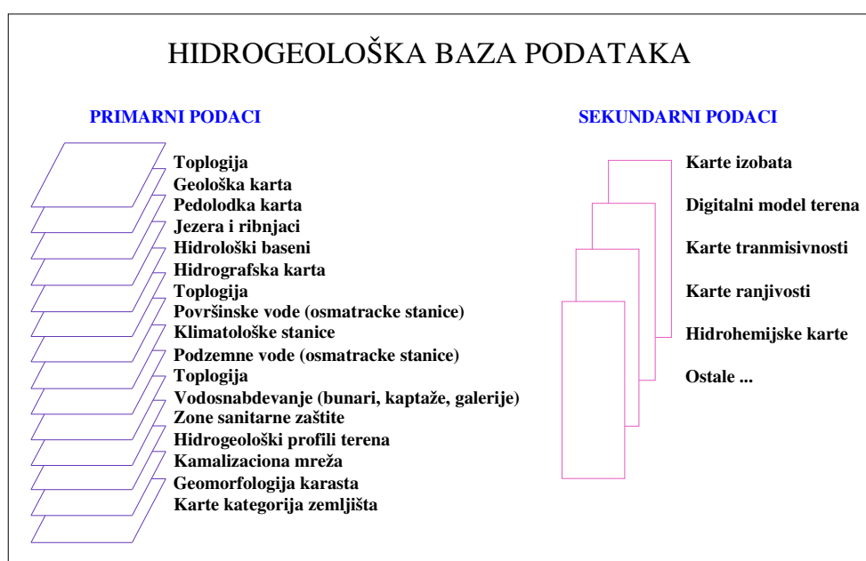
Slika 3. Primer hidrogeološke baze podataka (modifikovano iz Milenić, 2003)
