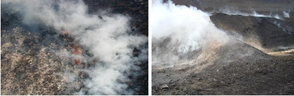
Слика 9.7. Самоупала угља и новонастали пепео (светлије боје)
