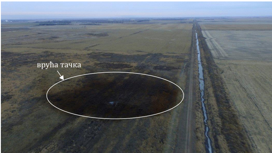
Слика 3.19. Пример вруће тачке услед изливања нафте из нафтовода на пољопривредно земљиште
