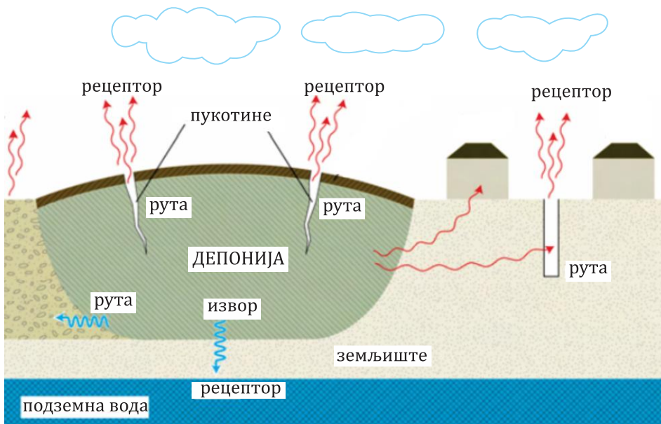
Слика 3.3. Дефинисање идејног модела на примеру депоније као извора загађења
