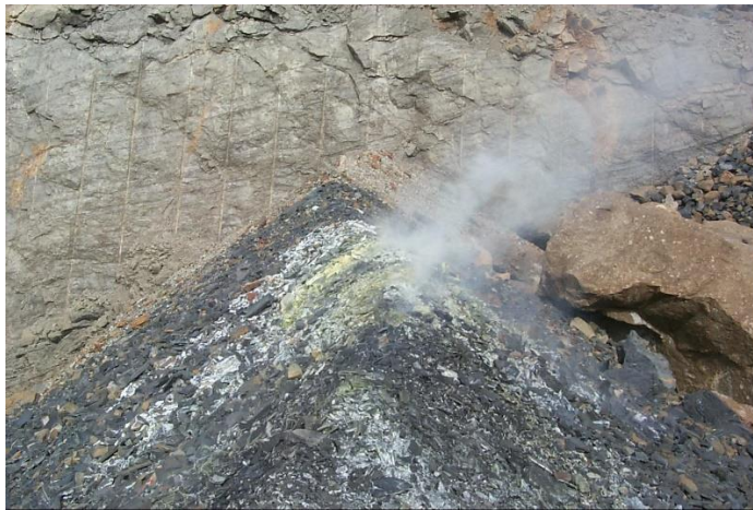
Слика 9.5. Ефекат оцака код самозапаљења отпада на гомили
