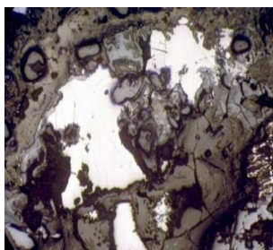
Оксидација и потискивање галенита англезитом и церузитом. Реликтни остаци пирита
