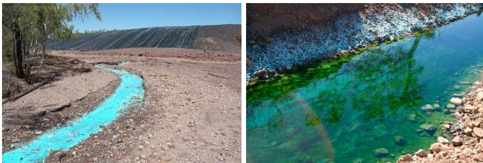
Слика 7.13. Процедна вода са јаловишта руде бакра (зелена боја због јона бакра)
