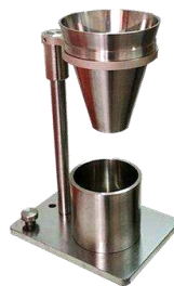
Слика 4.3. Уређај за одређивање насипне густине (маса)
