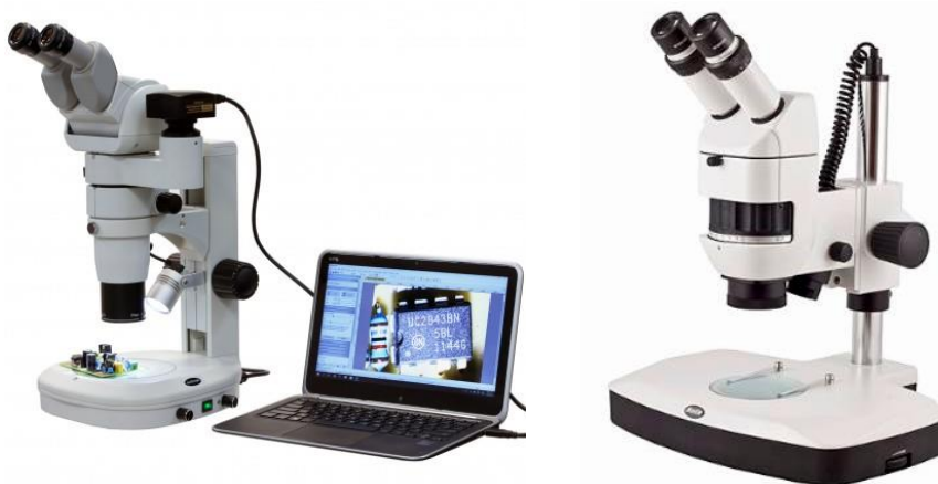
Слика 7.1. Савремене зум стерео бинокуларне лупе са илуминатором, дигиталном камером и СМО (Common Main Objektiv)
