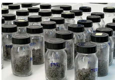
Слика 8.19. Узорци отпада и земљишног супстрата за тестирање ефекта на репродукцију Folsomia candida
