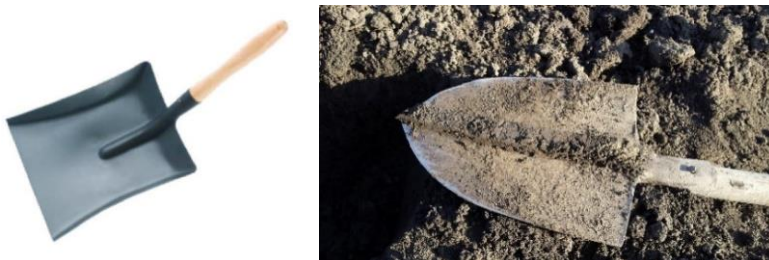
Слика 3.29. Лопатица (лево) и ашов за узорковање отпада (десно)
