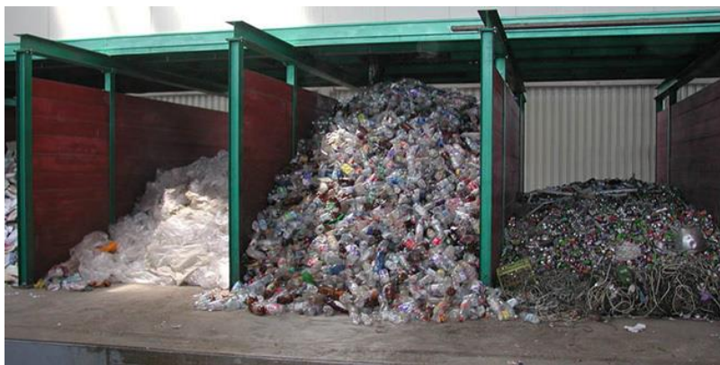
Слика 10.7. Изглед привременог складишта са боксовима за разврставање отпада
