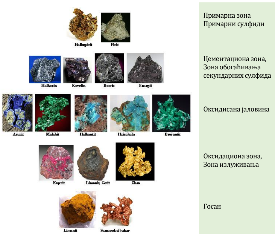
Слика 7.11. Илустрација оксидације на флотацијском јаловишту прерађене порфирске руде бакра
