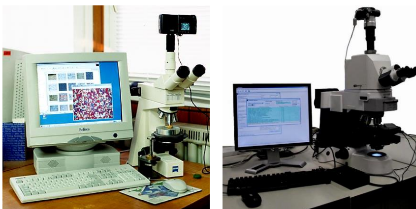
Слика 7.2. Типови оптичких микроскопа за рад у одбијеној светлости са дигиталном камером
