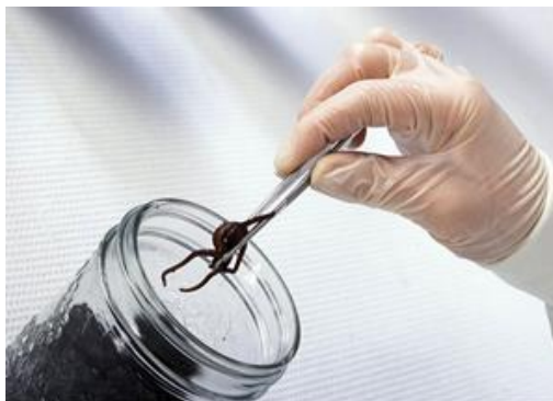
Слика 8.18. Утврђивање морталитета кишних глиста у контаминираним узорку
