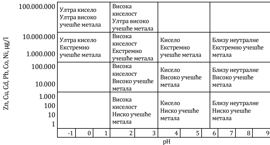
Слика 6.7. Фиклинов дијаграм геохемијске класификације воде у функцији pH вредности и учешћу растворљивих јона метала
