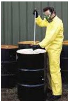
Слика 3.21. Цевасти узоркивач „COLIWASA“
