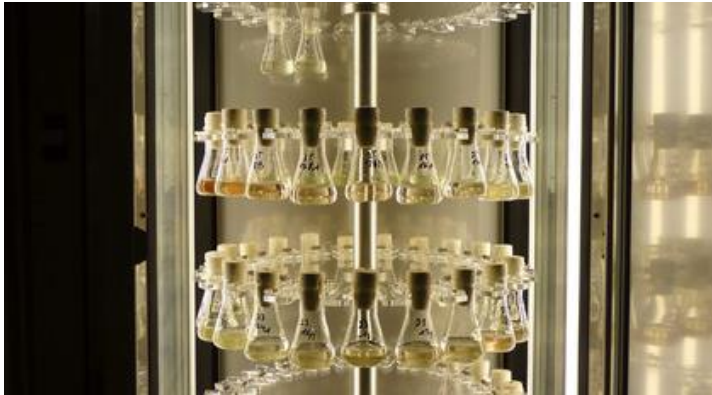
Слика 8.10. Културе слатководних зелених алги за испитивање екотоксичности растворљивих материја
