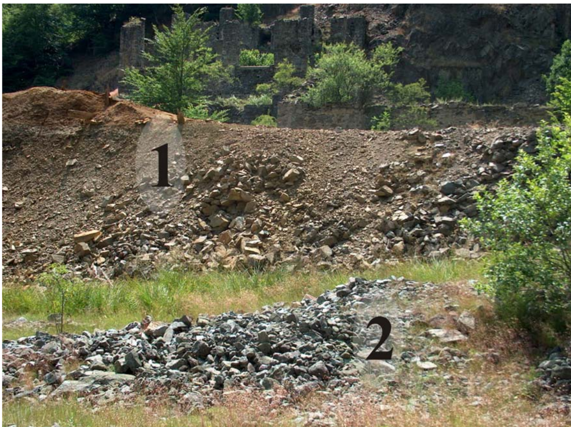
Сл. 19. Флотирана и рудничка јаловина у околини напуштеног постројења за флотацијску концентрацију руде у махали Кекеринци
