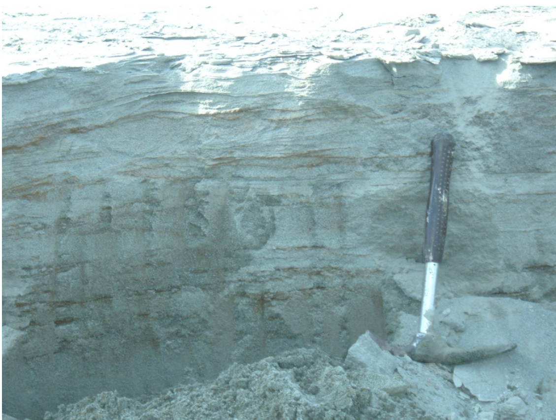
Сл. 28. Смена светлих и тамних минерала на профилу са великог платоа флотацијског јаловишта рудника Грот
