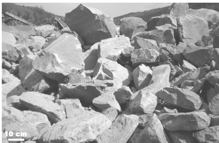
Slika 4.12-5: Nepravilni oblici prirodnih i miniranih blokova stenske mase (Kamenica).
