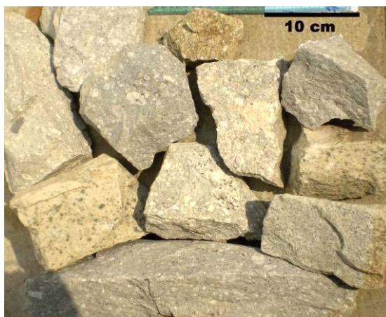
Slika 4.7-9: Variranje izgleda stene iz različitih delova stenske mase (Čeramide).
