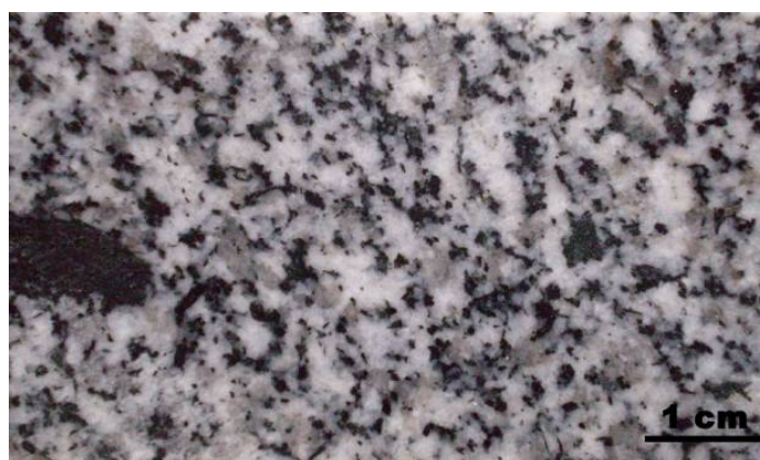
Slika 4.2-8: Izgled ravno sečenog uzorka granodiorita.
