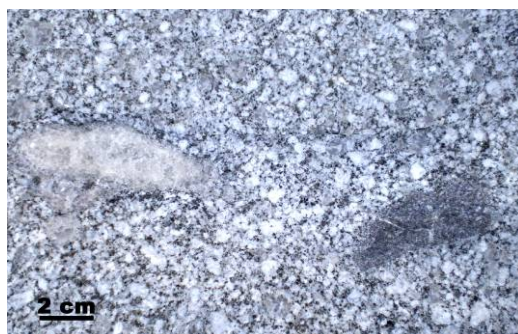
Slika 4.6-7: Krupan agregat kvarca (levo) i anklava/šlira (desno).
