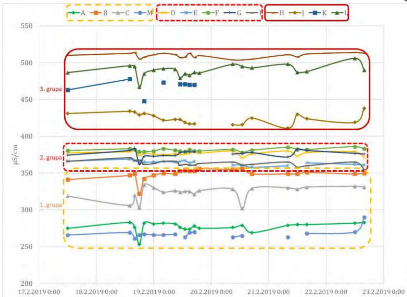
Слика 2. Дијаграм вредности специфичне електричне проводљивости измерених у пећини Печ током експеримента
