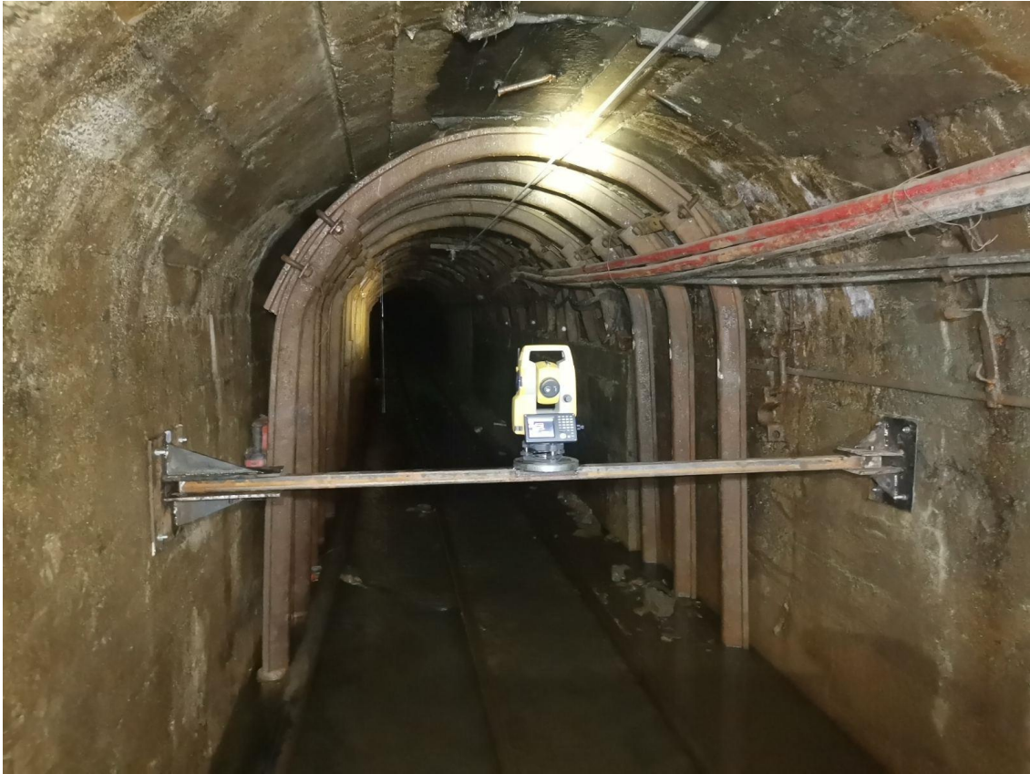
Слика 4.11 – Изглед склопиве конструкције носача тоталне станице која је коришћена у руднику „Грот“ – Крива Феја
