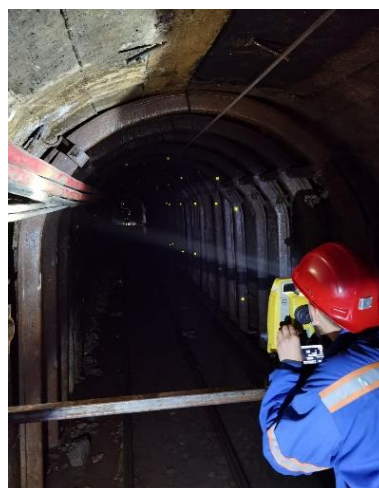
Слика 4.3 – Мерење позиције контролних маркера на подградној конструкцији у руднику „Грот“ – Крива Феја тоталном станицом Topcon OS-101
