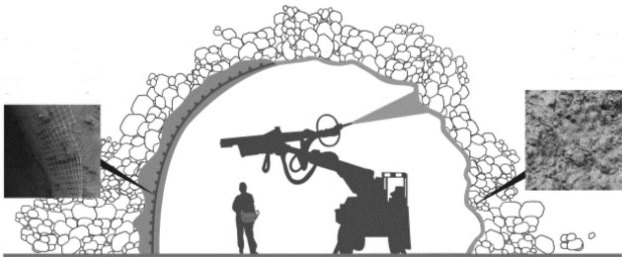
Слика 2.5 Уградња подграде од прсканог бетона (Putzmeister, 2022)
