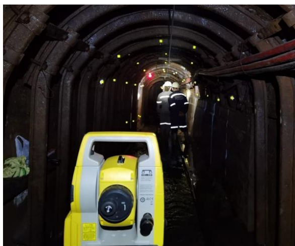
Слика 4.3 – Мерење позиције контролних маркера на подградној конструкцији у руднику „Грот“ – Крива Феја тоталном станицом Topcon OS-101
