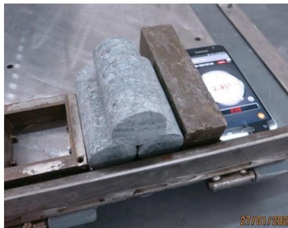
Slika 35. Opit naginjanja sa tri uzorka
