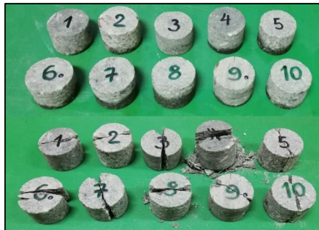
Slika 32. Izgled uzoraka pre i posle izvedenog Brazilijanskog opita
