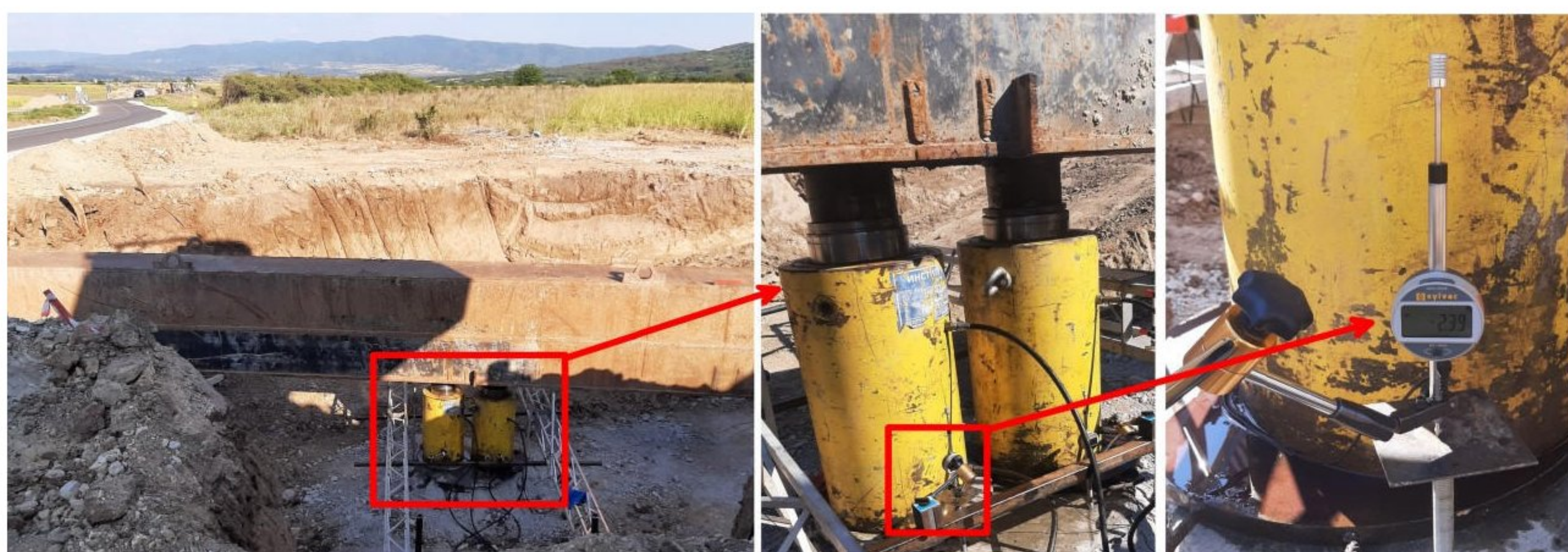
Slika 8. Konstrukcija sistema za opit probnog opterećenja šipa
