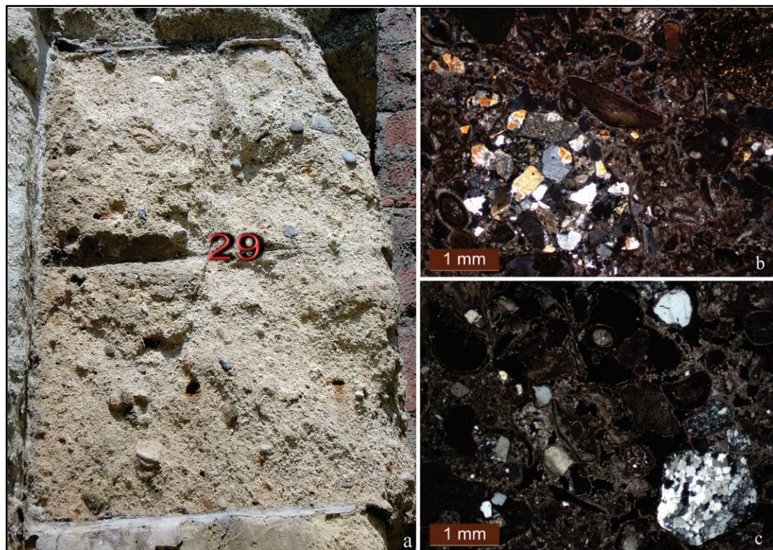
Sl. 51. Nečisti rudstone ; a) makroskopski izgled nečistog rudstone unutrašnje kapije Karla VI; b) krupan litoklast sa bioklastima u nečistom rudstone - uzorak 36 južne fasade Mračne kapije; c) klasti kvarcita i kvarca u nečistom rudstone - severna fasada Mračne kapije (Arhiva ZZSKGB)
