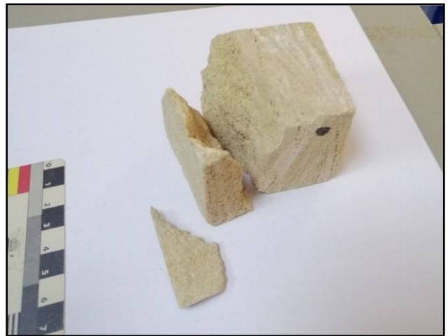
Sl. 112. Izgled preloma uzorka 43l duž ravni predisponirane lineacijom pri ispitivanju jednoaksijalne čvrstoće na pritisak
