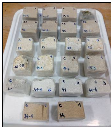
Sl. 35. Opitna tela pripremljena za tretman konsolidacije
