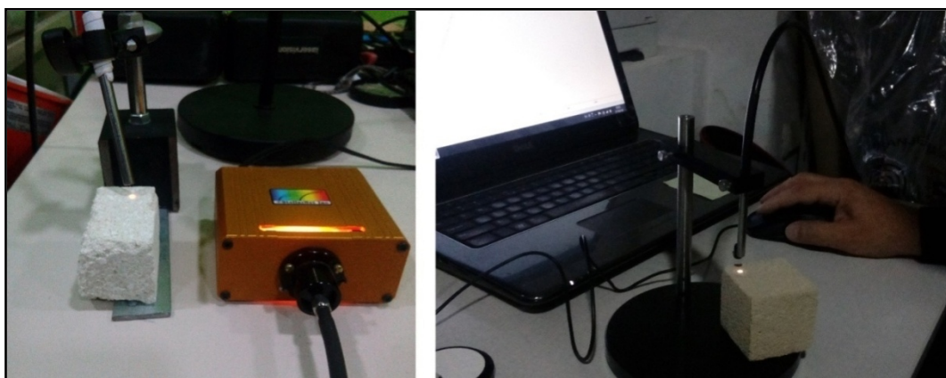
Sl. 33. Spektrofotometrijska analiza uzoraka pre i nakon konsolidacije
