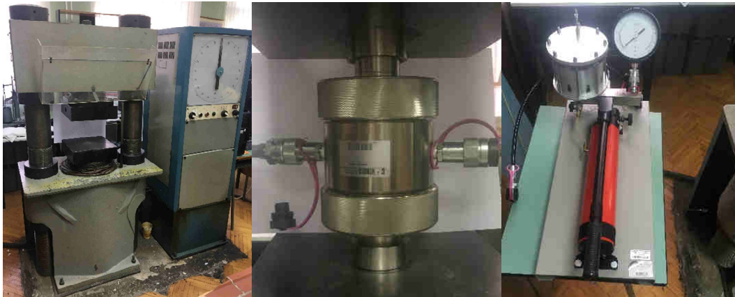
Слика 30. Опрема за испитивање троосне чврстоће на притисак: а) хидрауличка преса, б) Ноек-ова триаксијална ћелија и ц) пумпа за одржавање константног бочног притиска
