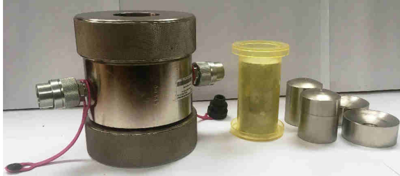
Слика 29. Основни делови опреме за испитивање троосне чврстоће на притисак
