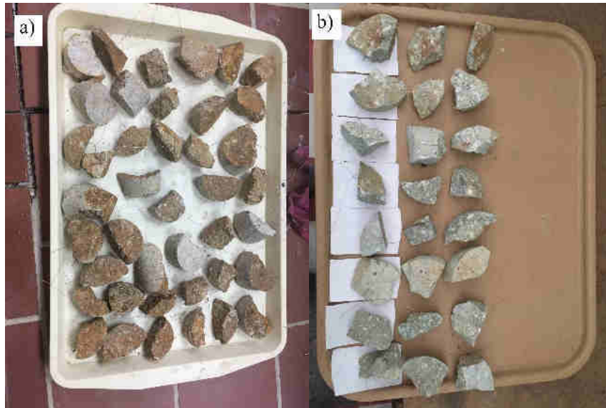
Слика 21. Припремљени узорци за испитивање запреминске тежине: а) АД, б) Д
