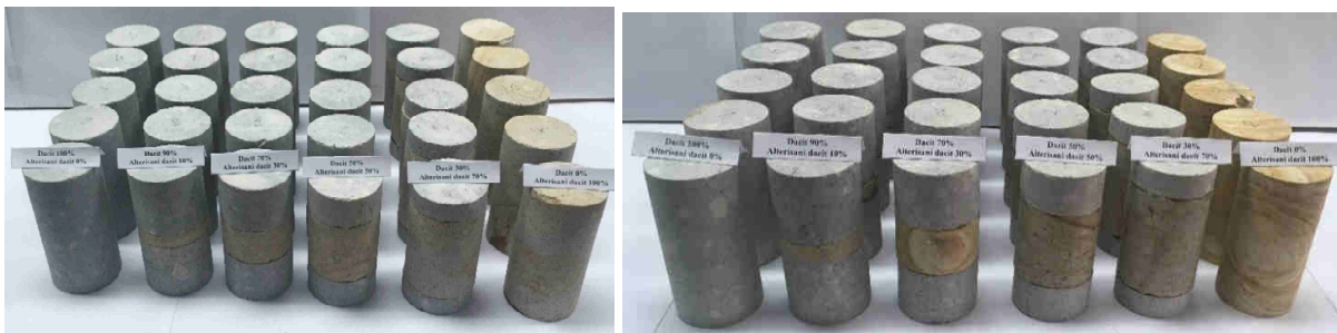
Слика 19. Изглед пробних тела припремљених за испитивање: а) једноосне чврстоће на притисак и б) троосне чврстоће на притисак
