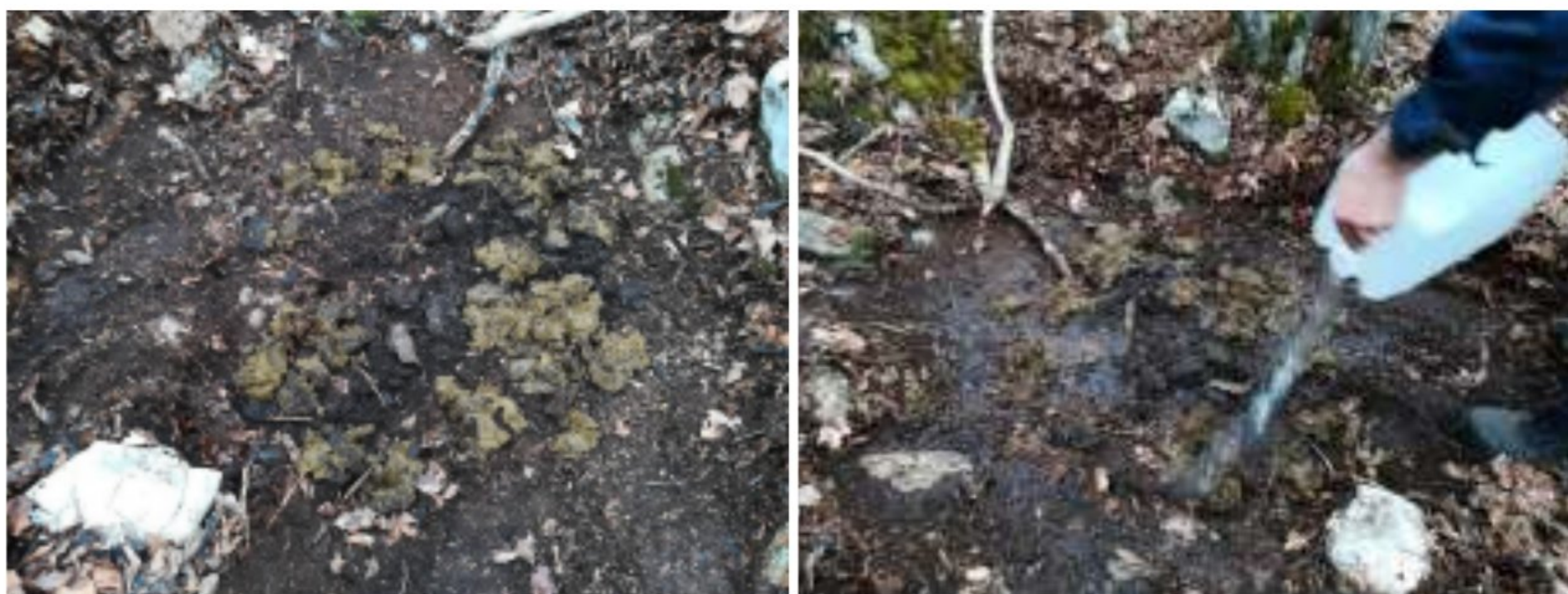
Slika 7.110. Nanošenje kontaminanta na lokaciji iznad pećine u vidu rastvora i čvrste materije (levo) i „ispiranje“ vodom iz bunara (desno)
