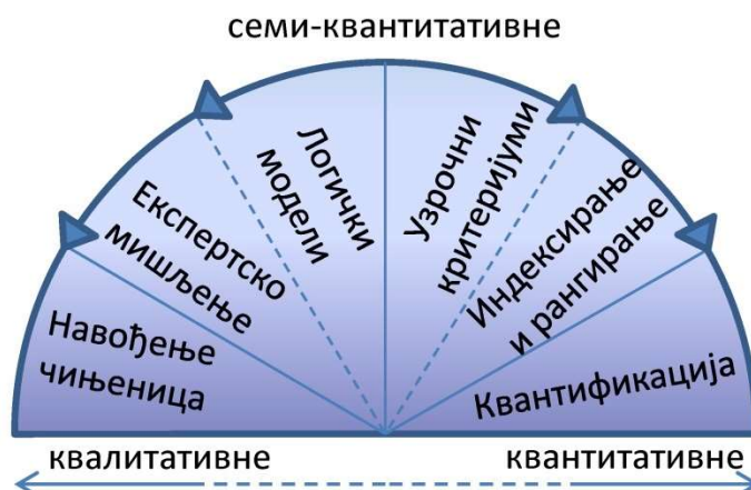
Слика 4-4. Основни приступи у анализи ризика у односу на начин на који се одређени критеријуми, алтернативе или последице разматрају и упоређују (модификовано према Linkov et al. 2009)
