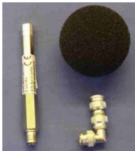
Slika 3-10. Mikروفon za merenje vazdušnog nadpritiska [96]
