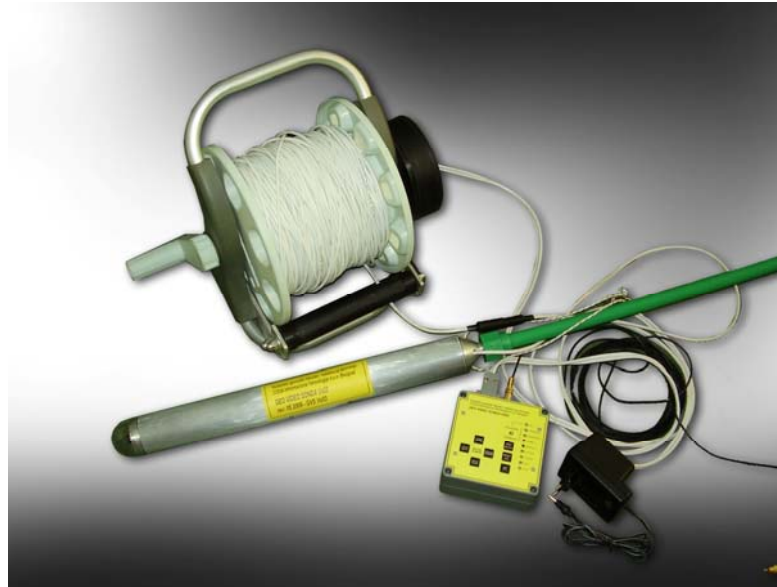
Slika 2-50. Vodootporna video sonda [84]
