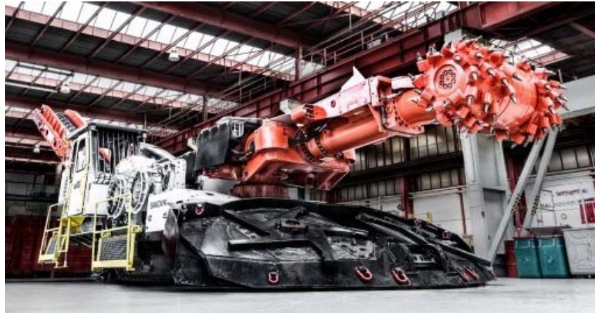
Слика 4.1- Комбинована машина „roadheader“ марке Сандвик MR361 [4]
