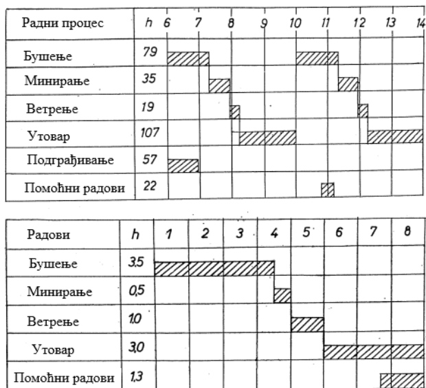
Слика 3.1. – Циклограм израде ходника бушачко-минерским радовима, а) један циклус у смени, б) два циклуса у смени [1]
