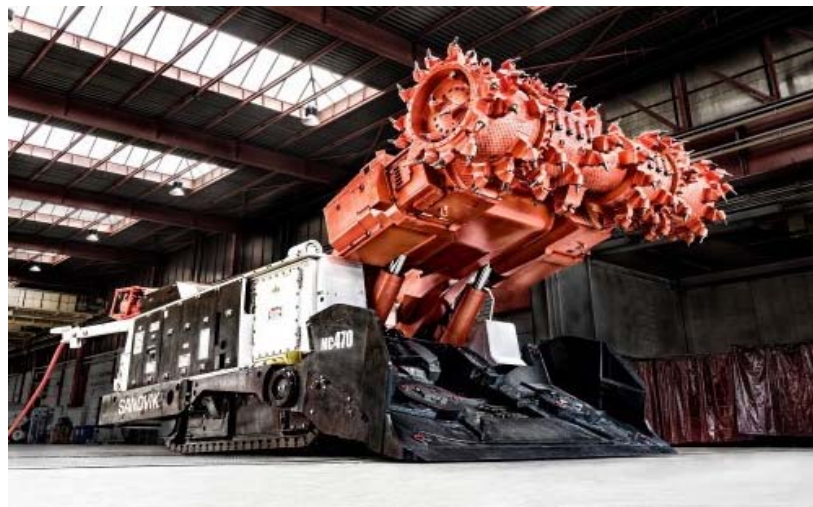
Слика 4.2 – Комбинована машина „continuous miner“ марке Сандвик MC470 [4]
