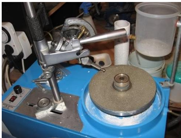
Слика 12. Машина на којој је извршено брушење и полирање равних површина јувелирских минералних сировина
