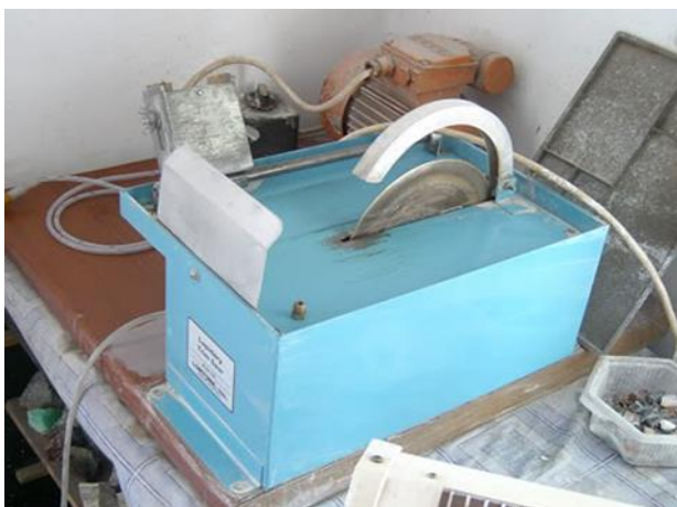
Слика 10. Тестера Lortone TS-8 на којој је извршено сечење узорка
