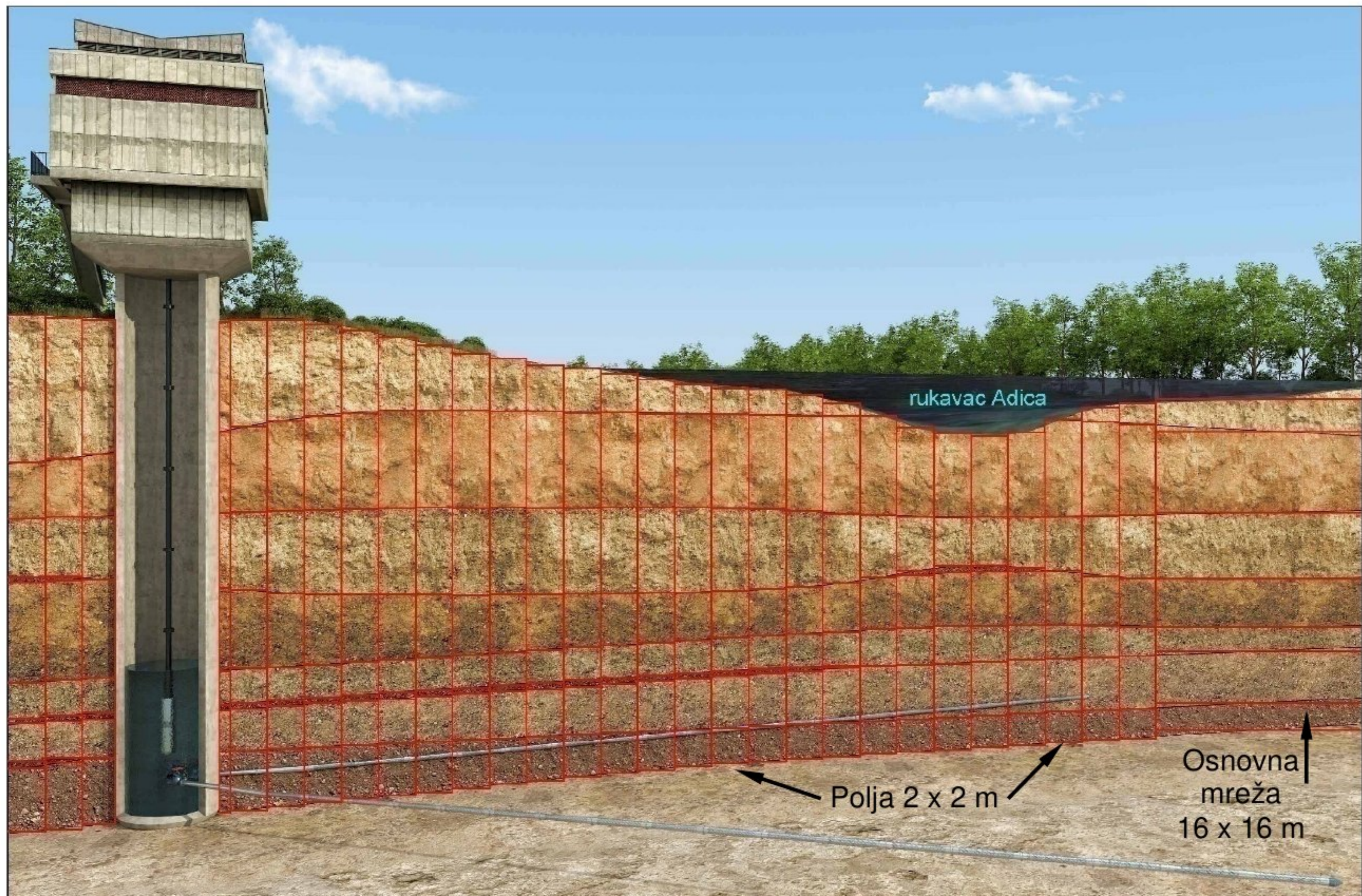
Slika 21: Prikaz primenjene diskretizacije prostora u profilu u zoni drenova bunara RB-5m upotrebom pravilne pravougaone umetnute mreže dimenzija 2 x 2 m (polja osnovne mreže su dimenzija 16 x 16 m)
