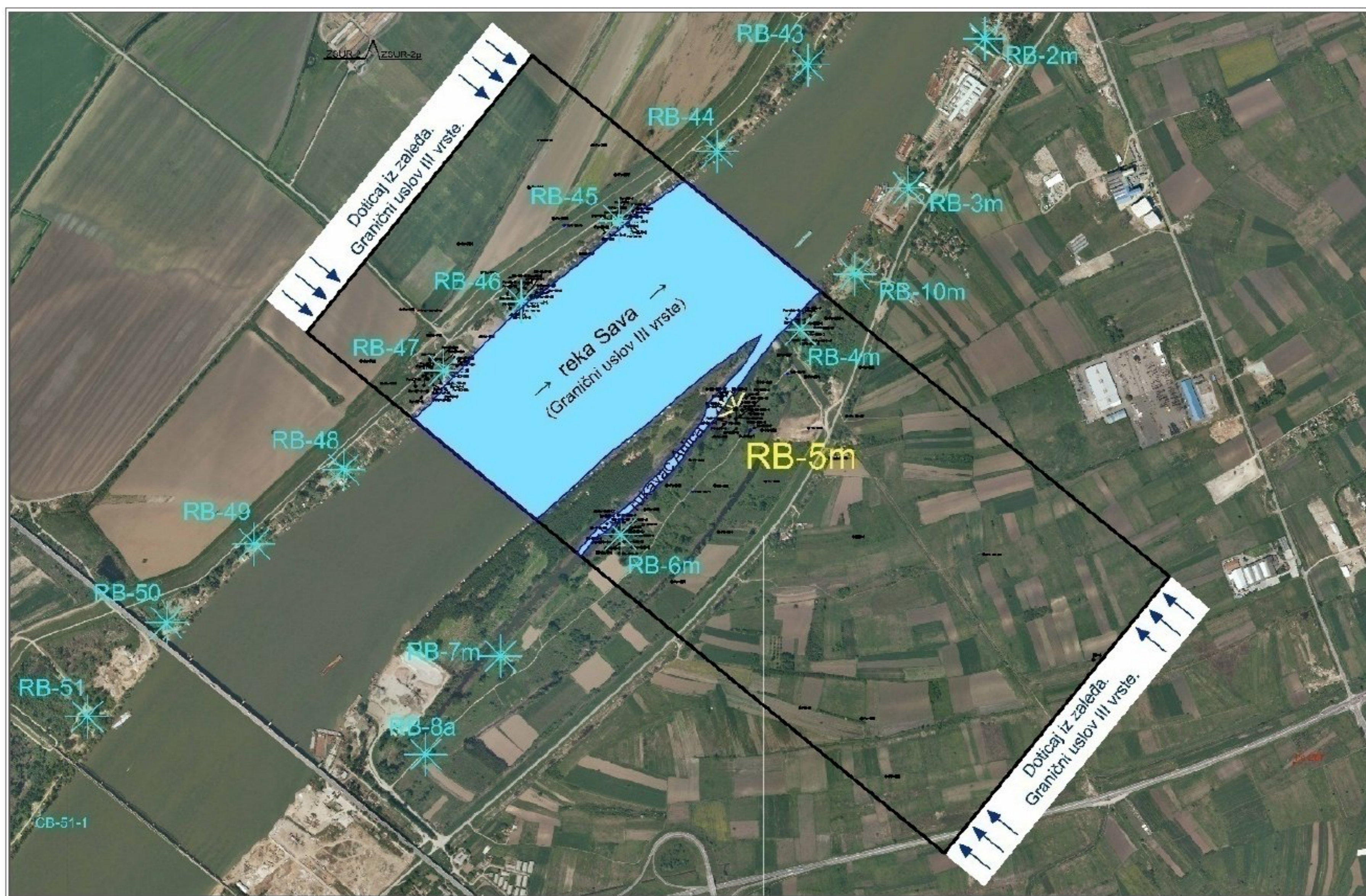
Slika 16: Granice 3D hidrogeološkog i hidrodinamičkog modela, sa položajem bunara, istražnih bušotina korišćenih u šematizaciji izdani i graničnim uslovima (Božović et al., 2022)
