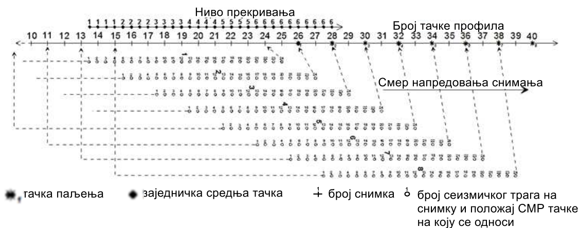
Слика 3.22 – Шема снимања са 24 активна канала, шестоструко прекривање
