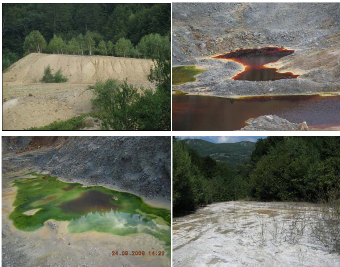
Сл. 7. Ручно пребран материјал (горе лево), воде са врха Бобије и јаловина након дробљења и сепарисања (доле десно)
