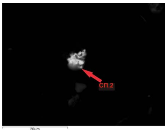
Сл 40. Агрегат минерала из репрезентативног полираног узорка величине зрна < 0.1 mm - јужни део великог платоа флотацијског јаловишта рудника Грот
