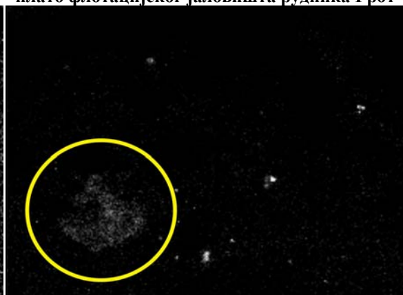
Сл. 97. Концентрације S у оксидној (сулфидној, силикатној) класи минерала. (табела 28) - јужни плато флотацијског јаловишта рудника Грот
