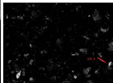
Сл. 72. Нагомилања Fe у минералу сулфидне (оксидне) класе. Репрезентативни неполирани узорак величине зрна 0.5 - 0.8 mm - велики платоа флотацијског јаловишта рудника Грот
