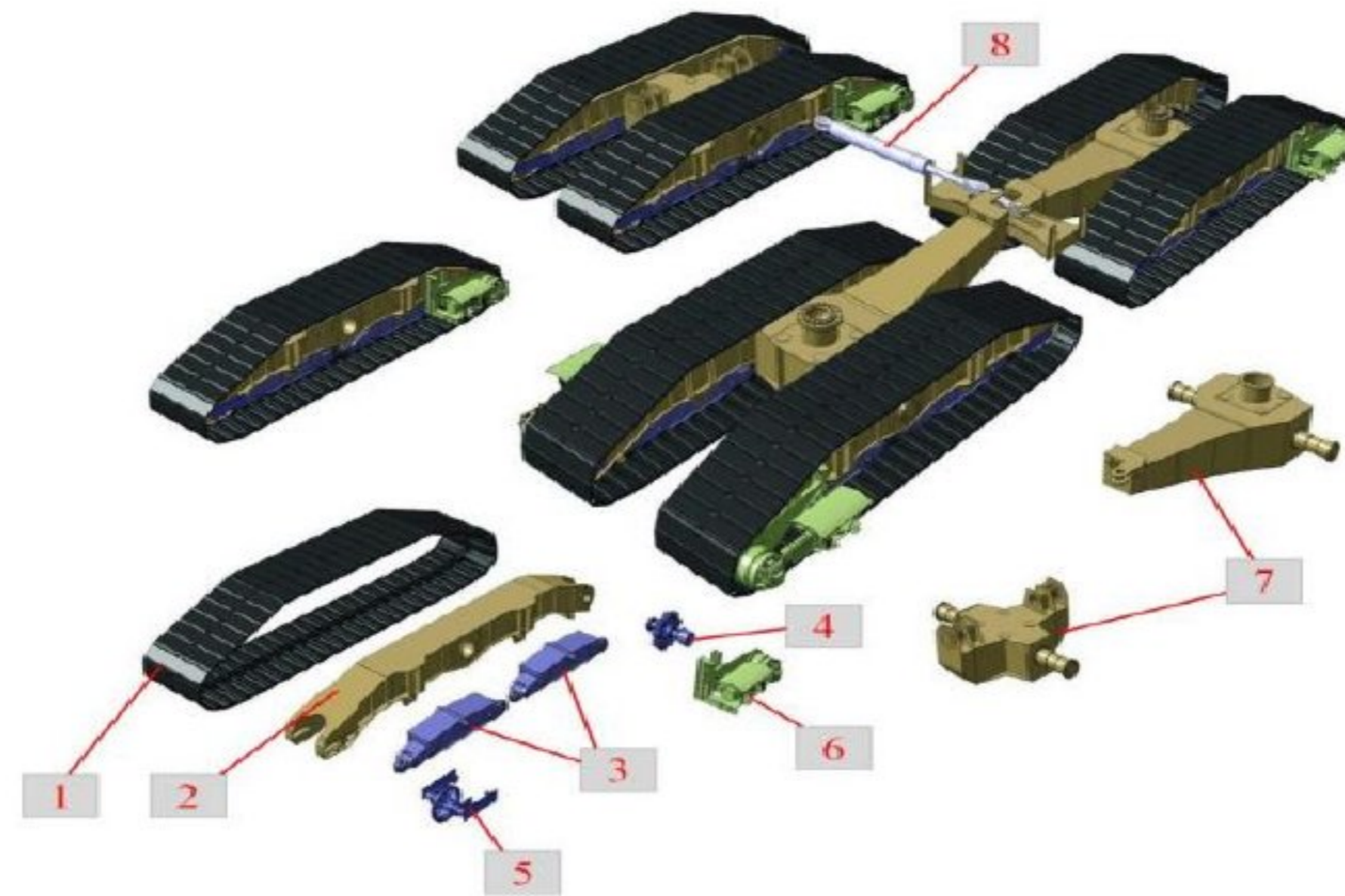
Слика 12. Елементи гусеничног транспортног уређаја [3]
