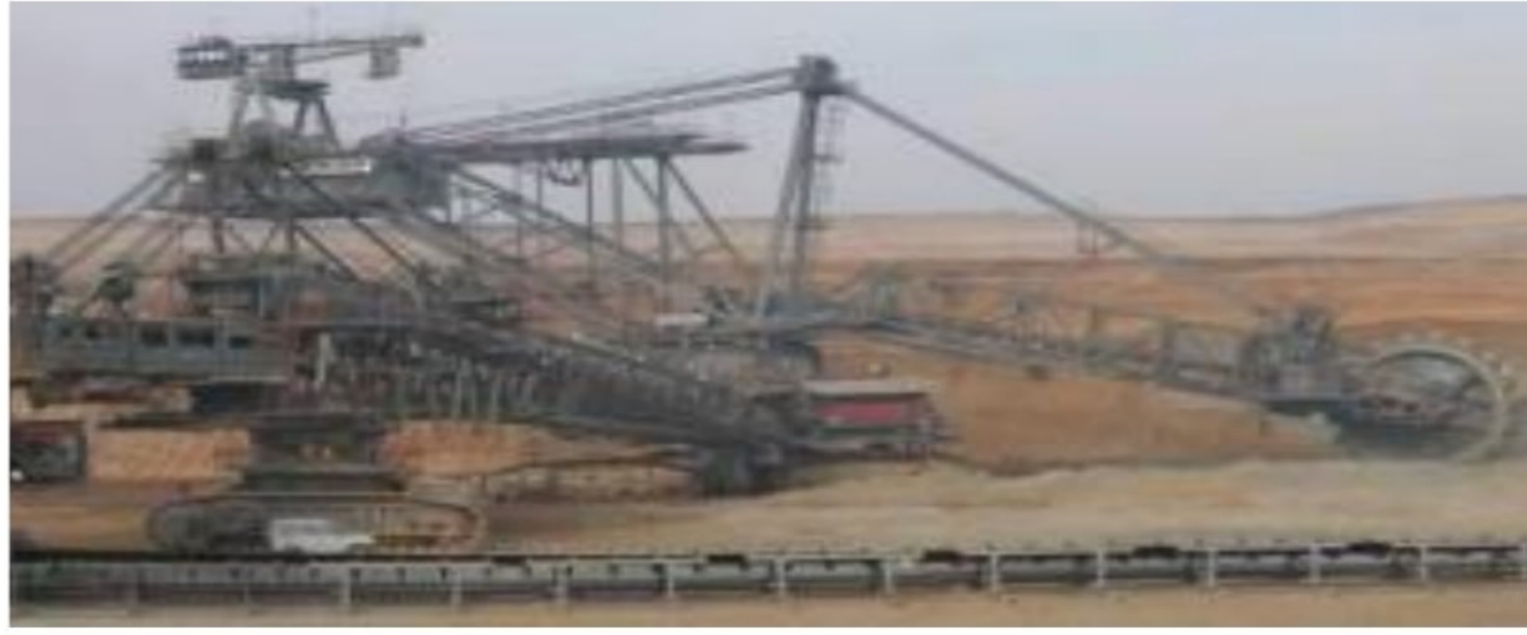
Слика 16. Конструкција стреле у облику решетке[3]
