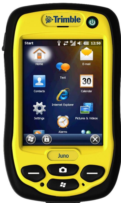
Слика 9. Уређај за регистровање клизишта на терену
