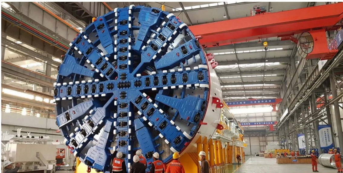
Slika 26. EPB mašina u radionici (izvor: sajt www.creg-germany.com )
