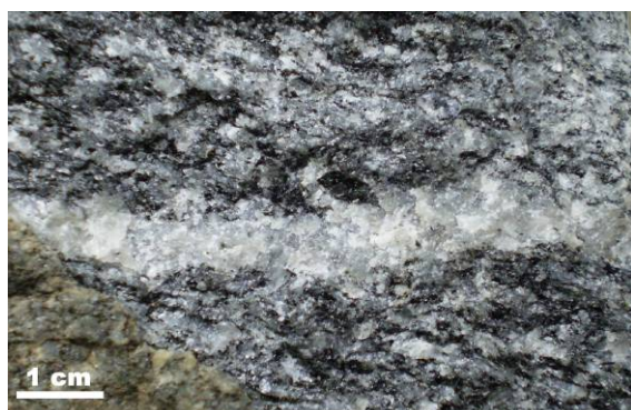
Slika 4.2-6: Planparalelna tekstura granodiorita.
