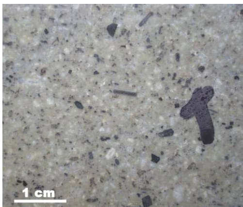
Slika 4.13-10: Izgled ravno sečene površine kamena.
