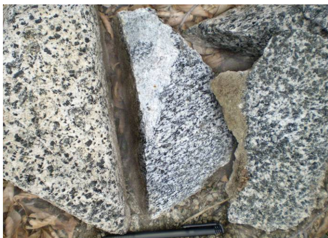
Slika 4.10-4: Nehomogen izgled usled planparalelne teksture i litaža (Šumska kuća).
