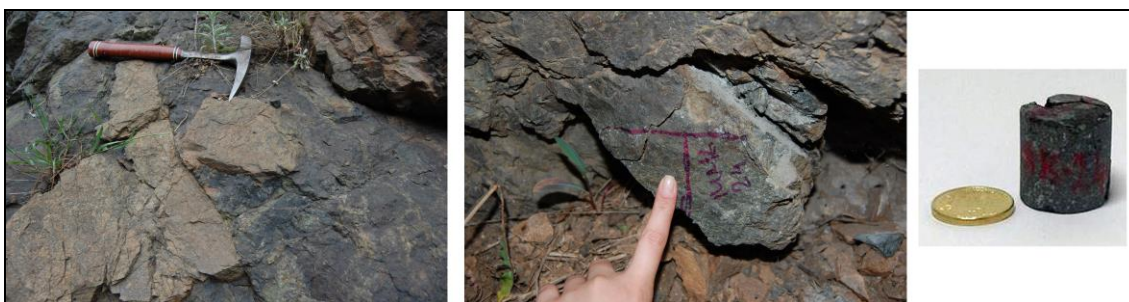
Slika 11. Fotografije uzorka na terenu (levo), orijentisani uzorak (u sredini) i uzorak pripremljen za laboratorijsku analizu (MAK 24 - dijabaz, desno)
