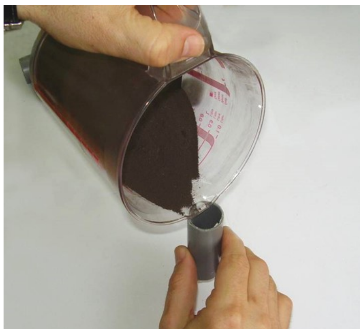
Слика 5. Пуњење пластичне патроне неексплозивном горивом мешом
