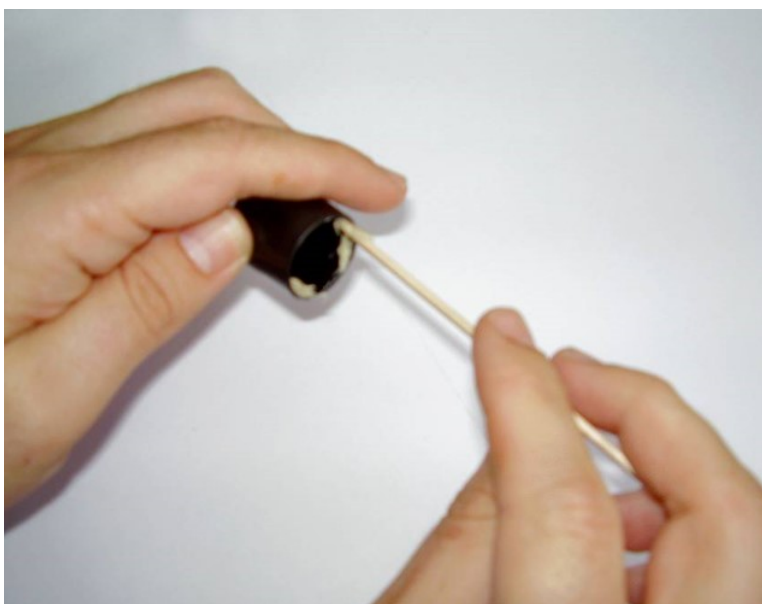
Слика 4. Наношење слоја брзовезујућег лепка на пластични чеп
