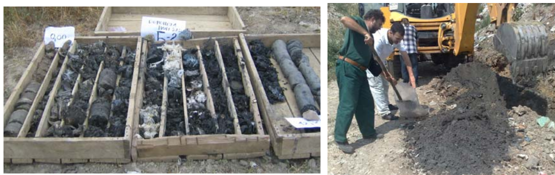
Slika 4.17 Komunalni otpad iz istražne bušotine i istražne jame sa deponije u Novom Sadu
