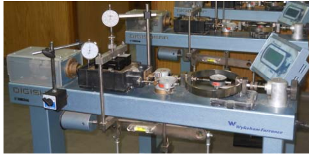
Slika 6.58. Aparat za direktno smicanje sa dimenzijama kutije 100 x 100 mm – IMS Beograd
