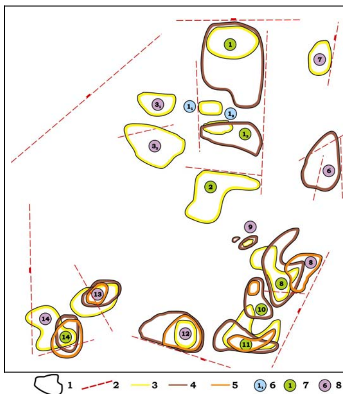
Slika 72. Pregledna skica geoloških blokova drugog sloja antrecita u eksploatacionom polju „Mala Čuka“ (Stakić 2006)
