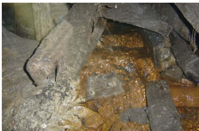
Slika 109. Isticanje rudničke vode iz zatvorenog otkopnog hodnika OH-810 jame rudnika „Štavalj“ (foro B.Miladinović)
