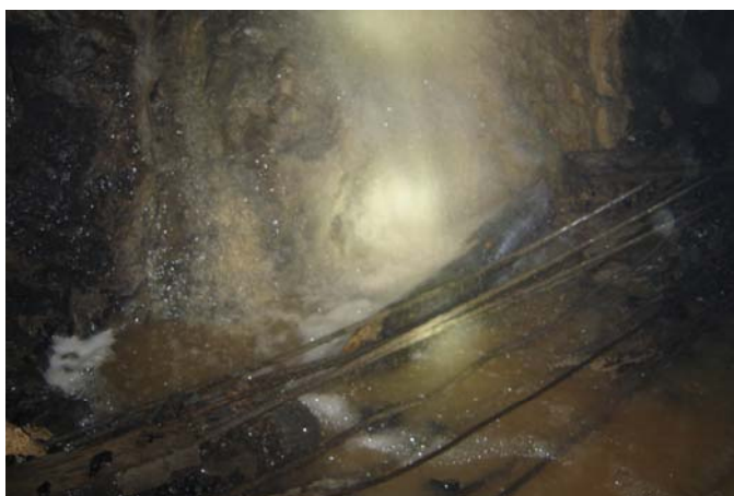
Slika 141. Priliv rudničkih voda iz krečnjaka u niskop GN-1 jame "Strmosten" (foto B.Miladinović)
