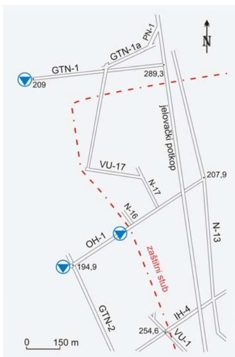
Slika 143. Lokacije pojave rudničkih voda u jami „Jelovac“ (podloga: plan jame Bačić-Vlahović 2006) ● - mesto priliva rudničkih voda
