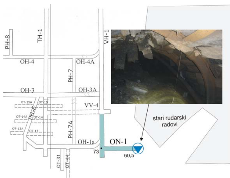
Slika 187. Plan dela jame rudnika „Lubnica“ u kome je došlo do potapanja rudarskih prostorija iznenadnim prilivima iz starih rudarskih radova 10.12.2008. god. ▼ - mesto pojave priliva rudničkih voda (foto B.Miladinović)
