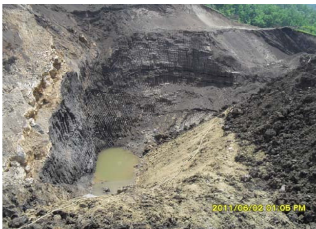
Slika 135. Vodosabirnik na najnižoj etaži površinskog kopa "Progorelica" (foto S.Bošković)
