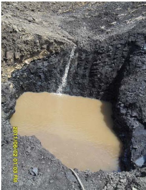
Slika 100. Prilivi iz povlatnih pešćara na kontaktu sa ugljem na površinskom kopu „Progorelica“ (foto S.Bošković)
