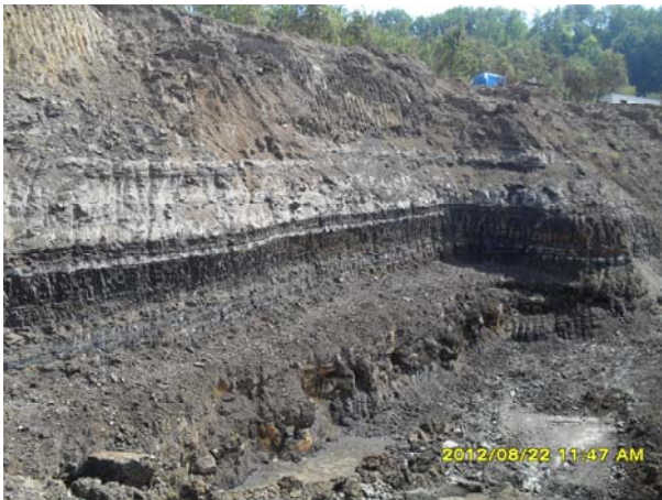
Slika 64. Izgled gornjeg sloja kamenog uglja sa neposrednom podinom i povlatom u ležištu „Progorelica“ (foto S.Bošković)
