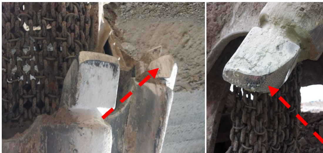
Slika 8.15. Prikaz loše geometrije zuba na bageru ER-1250 16/1,5
