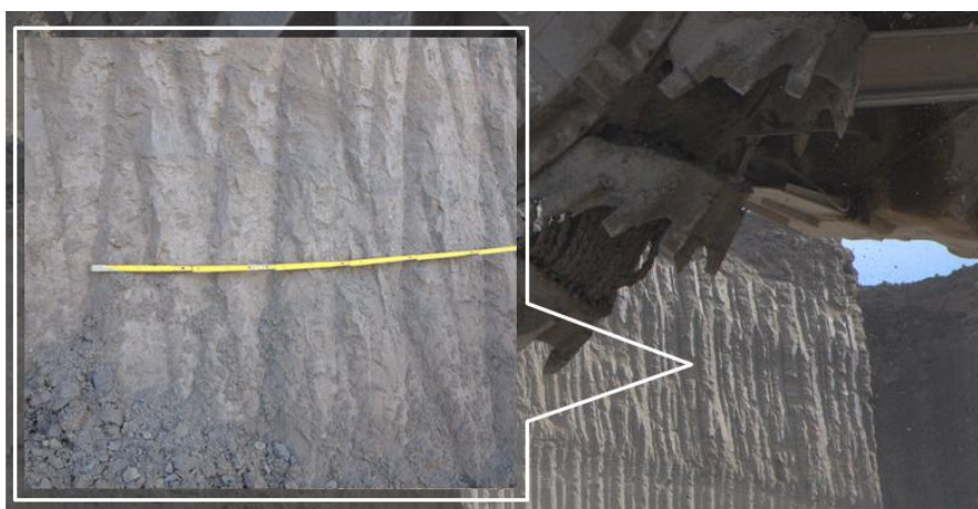
Slika 2.3. Brazde koje u ostavljaju zubi na rotoru bagera u stenskom materijalu
