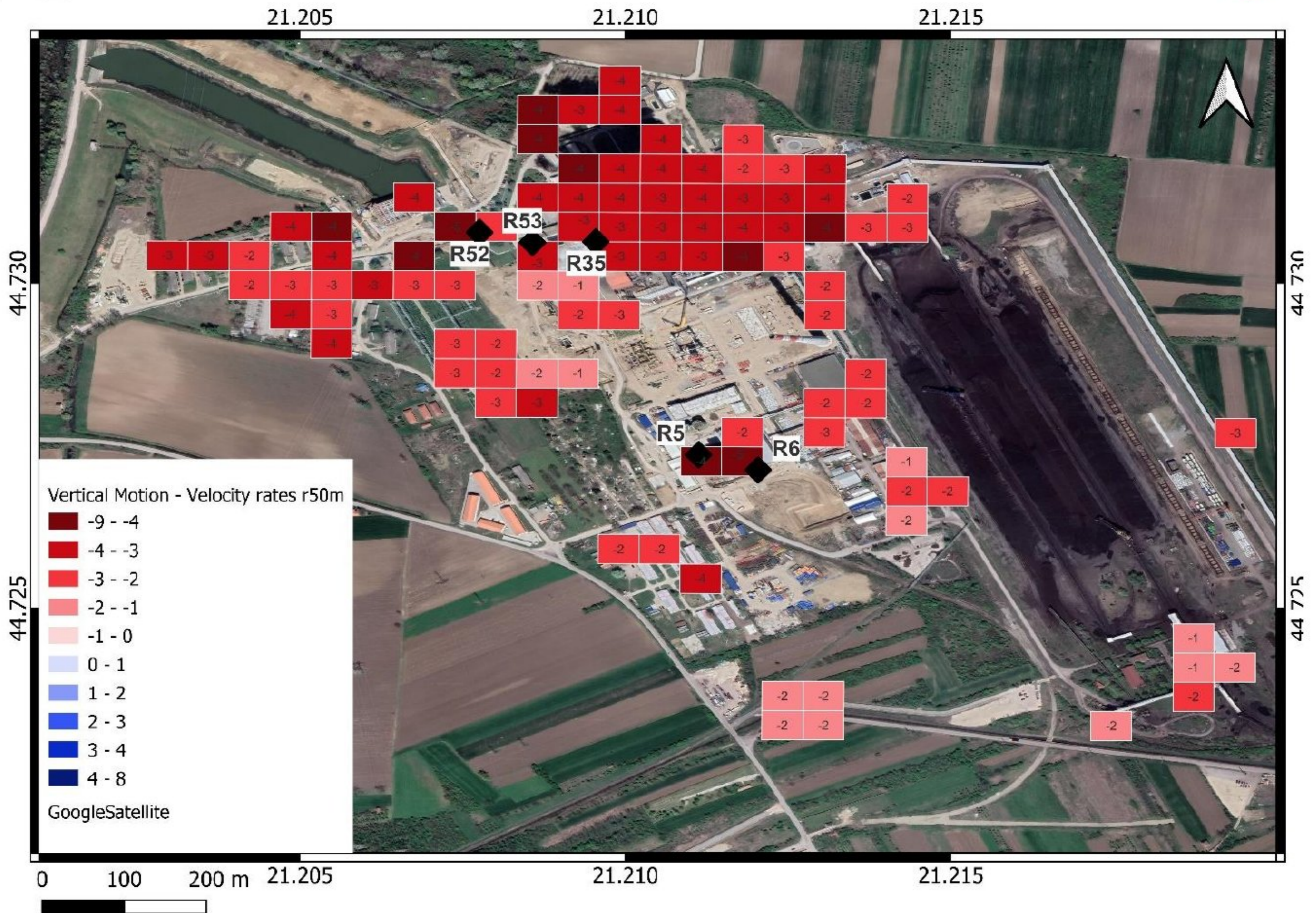
Слика 86. Вертикална брзина слегања PS (mm/god) за подручје ТЕКО; нијансе црвене боје представљају негативна померања PS (слегања), нијансе плаве боје представљају позитивне вредности за PS (издизање) (величина резолуционе ћелије је 50 метара). Црни ромбови представљају репере нивелманске мреже, (Гојковић и др., 2023).
